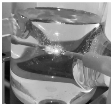
図3 硫酸マグネシウム水溶液中で発生させたソリューションプラズマ。
