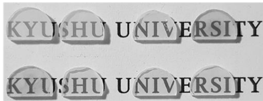
図3 1500°Cで焼結した透光性 Y_2O_3 の外観
