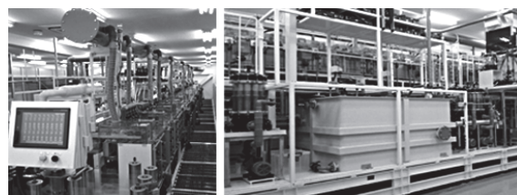
写真 1 ロール to ロールめっきライン 250mm 幅 縦型搬送
